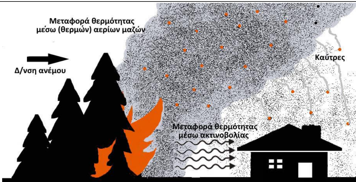
Σχέδιο 3. Τρόποι ροής της θερμότητας σε μια δασική πυρκαγιά, που εξελίσσεται πλησίον κτιρίου και απεικόνιση πιθανού τρόπου μετάδοσης δασικής πυρκαγιάς με μεταφερόμενες καύτρες σε κτίρια παρουσία μέτριου ανέμου
